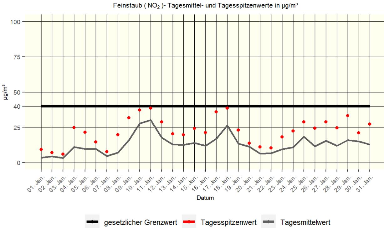
Die Stickstoffoxide sind von großer lufthygienischer bedeutung. Stickstoffdioxid entsteht prinzipiell als Nebenprodukt bei verbrennungsvorgängen durch die Oxidation von Luft ( $NO+O=NO_2$ ). Es ist ein braunrotes, süßlich riechendes Gas und stammt aus den Abgasen von Industrie, Gebäudeheizungen und Verkehr.  $NO_2$  reagiert mit Wasser zu Salpetersäure.
